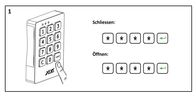
Funktion durch vierstelligen Code. Der Code wird jedes Mal, wenn das Schloss geöffnet wird, gelöscht, damit ist es für einen neuen Benutzer bereit.
