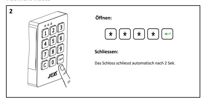
Funktion durch vierstelligen Code. Der Code ist für einen Dauerbenutzer mit Schrankzuordnung.
